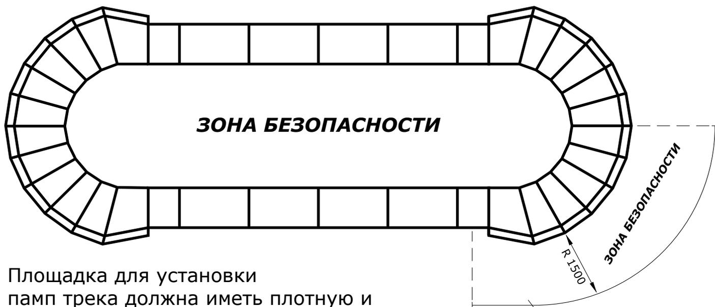
Площадка для установки памп трека должна иметь плотную и ровную поверхность, способную выдерживать вес конструкции, а так же обладать необходимой площадью не только для самого памп трека, но и для **зоны безопасности**, вокруг памп трека в радиусе **полутора метров**.
